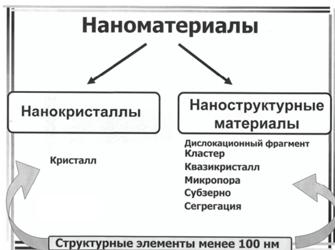
Рис. 1.4. Общая классификация наноматериалов
