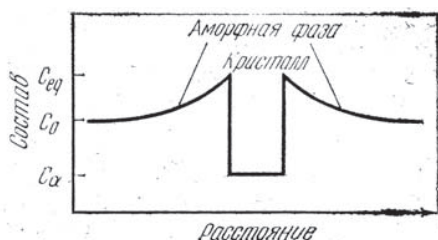
Рис. 1.23. Концентрационный профиль, возникающий при наличии первичного кристалла
