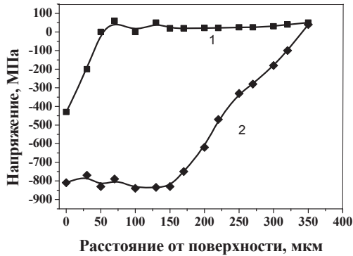
Рис. 2.18. Распределение остаточных напряжений от свободной поверхности в глубину образца из стали 4Х5МФ1С: 1 – до УЗО, 2 – после УЗО.
