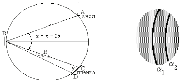
Рис. 6.6. Рентгенограмма монокристалла по Иогансону и схема строения лауэвского рефлекса: AB – направление падающего луча; BC – направление отраженного луча ( BC = R ); DC = y – величина смещения линии на рентгенограмме
