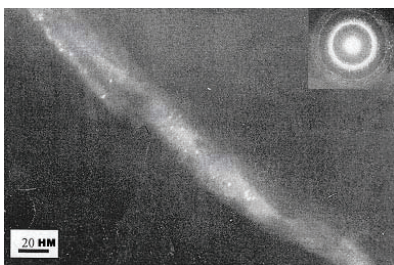
Рис. 1.29 Электронно-микроскопическое изображение кристаллизовавшейся локальной полосы сдвига в аморфном сплаве \text{Ni}_{44}\text{Fe}_{29}\text{Co}_{15}\text{Si}_2\text{B}_{10} после МПД ( N = 0,5 ; T = 293 К)
