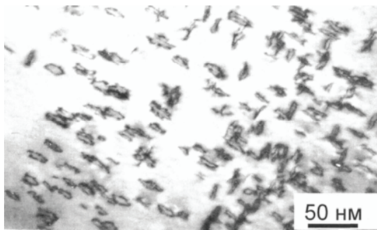
Рис. 1.8. Структура нанодислокационного материала. В сплаве Fe–Cr–Al, закаленном из жидкого состояния, наблюдается высокая объемная плотность призматических дислокационных петель вакансионного происхождения; ПЭМ
