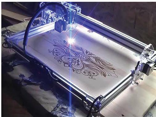
Рис. 206. Процесс лазерной гравировки
