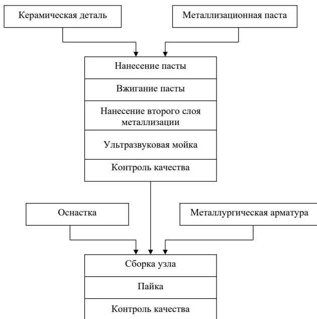
Рис. 4. Последовательность технологических этапов соединения металла с керамикой
