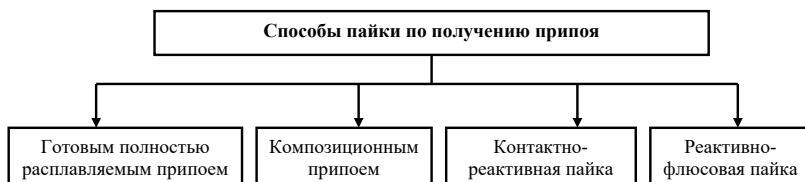
Рис. 2. Классификация способов пайки по получению припоя
