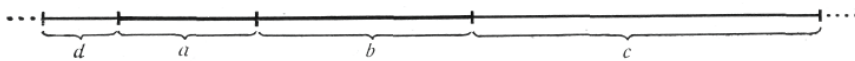
Рис. 6. Среднее пропорциональное или деление отрезка в крайнем и среднем отношении: d = b - a ; c = a + b
