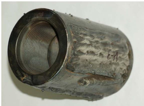
Рис. 2. Наплавленная муфта
