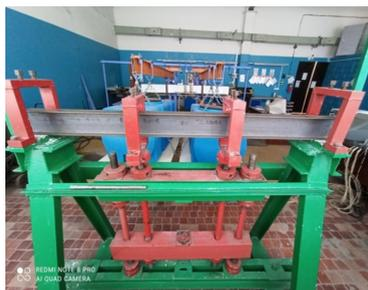
Рис. 1. Установка для испытания балочных конструкций
