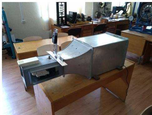
Рис. 1. Стенд для определения влияния коэффициента аэродинамического сопротивления на изменения нагрузки на ось автомобиля
