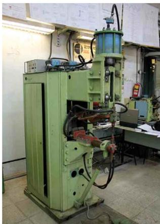
Рис. 1. Машина контактной сварки МТПУ300
