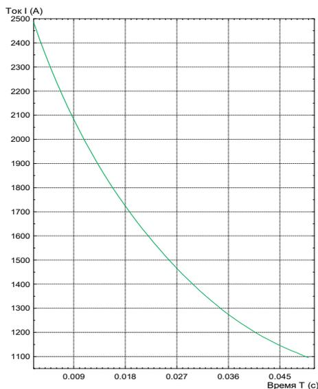
Рис. 5. Временная зависимость тока в режиме «закоротки» через диод
