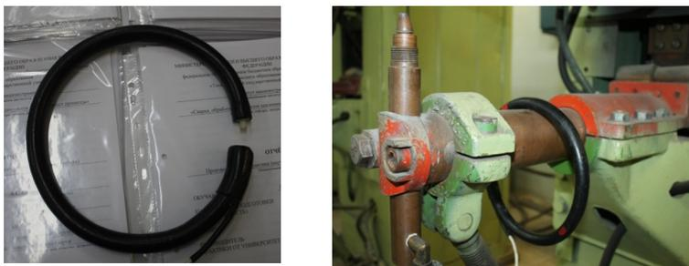
Рис. 4. Установка пояса Роговского на хоботе во вторичном контуре контактной сварочной машины
