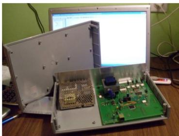
Рис. 5. Система компьютерного управления контактной сваркой СК300
