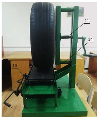
Рис. 4. Лабораторная установка для определения углов увода колеса автомобиля (вид сбоку)
