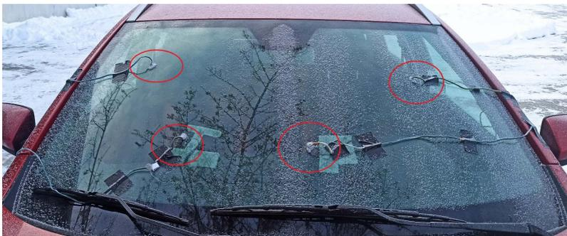
Рис. 4. Установка термопар на ветровом стекле автомобиля
