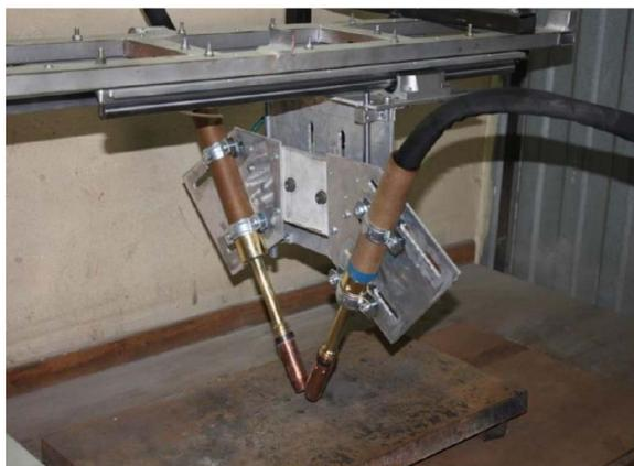
Рис. 1. Установка двухдуговой наплавки [2]
