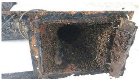
Рис. 1. Демонтированный водоприемник из углеродистой стали Новолядовского водозабора на р. Сытва [1]
