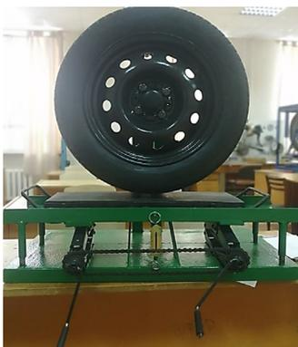
Рис. 2. Лабораторная установка для определения углов увода колеса автомобиля
