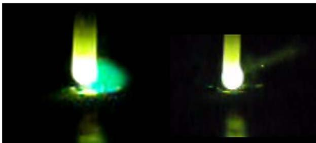
Рис. 3. Кадры скоростной видеосъемки свободной дуги длиной 2 мм,  $d = 3$  мм,  $I = 40$  А
