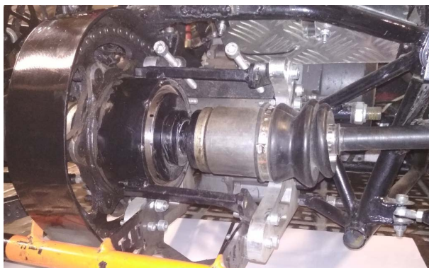
Рис. 1. Дифференциал «Torsen» T2 на болиде команды «Togliatti racing team»
