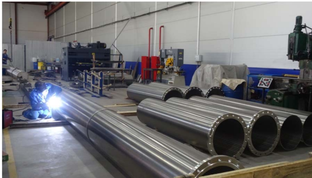
Рис. 2. Производство подрулового фильтрующего элемента из сегментов с кольцами жесткости
