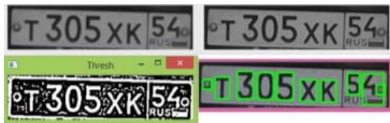
Рис. 3. Пример работы алгоритма Виолы-Джонса для распознавания автомобильных номеров
