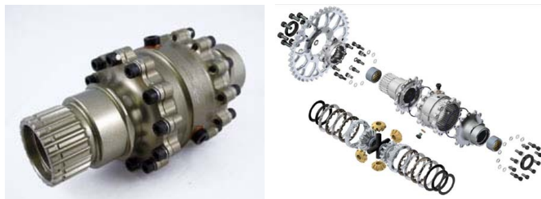
Рис. 2. Внешний вид и устройство дифференциала «Drexler»
