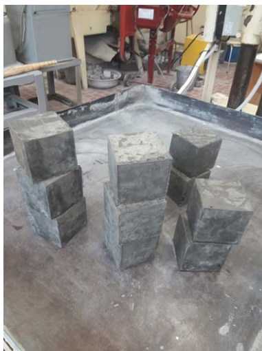
Рис. 2. Контрольные образцы бетона для испытаний на прочность
