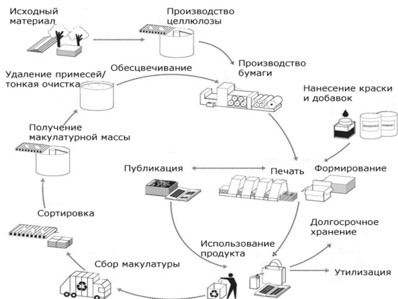
Рис. 1. Схема процесса переработки макулатуры в общем цикле производства и потребления бумажной продукции
