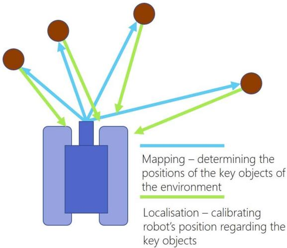
Fig. 6.2. Robot Mapping
