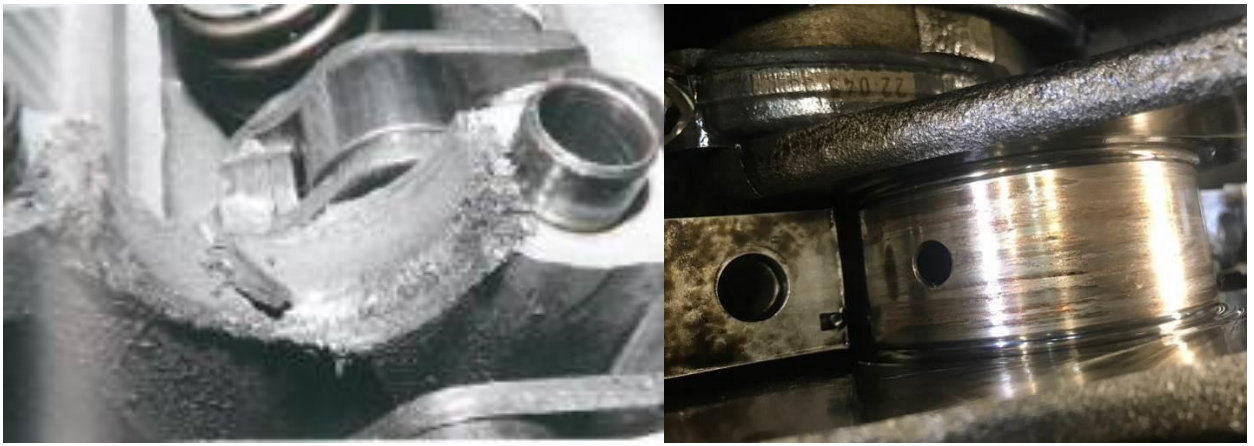
Рисунок 8 - Разрушение постелей подшипников и изнашивание шейки коленвала
