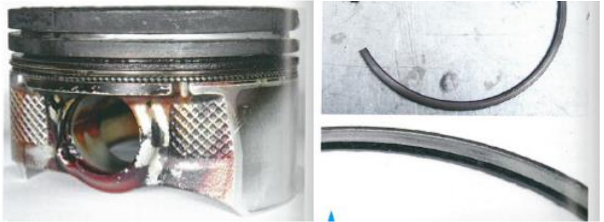
Рисунок 2 - Размытая верхняя канавка на поршне, разрушенное верхнее кольцо без признаков нормальной приработки к канавке и аномально сильно изношенное среднее кольцо – комплекс признаков с крытого производственного дефекта (поломку верхнего кольца при сборке двигателя).
