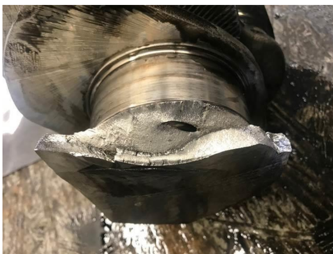
Рисунок 6 – Усталостное разрушение коленчатого вала двигателя
