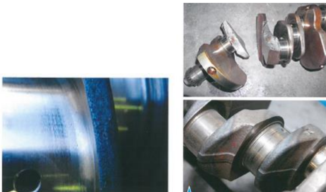
Рисунок 5 - Типичный дефект ремонта коленчатого вала: грубая шлифовка и подрезка галтелей прямо ведет к поломке коленвала.
