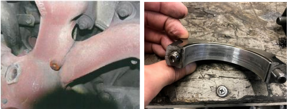
Рисунок 7 – Трещины термоусталости в выпускном коллекторе и следы побежалости на вкладыше коренного подшипника
