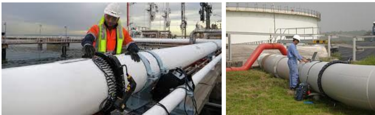
Рисунок 11 – Расположение датчиков и излучателей при низкочастотной ультразвуковой диагностике магистрального трубопровода
