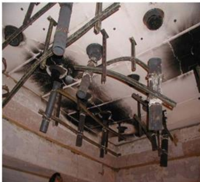
Рисунок 13 – Результаты до проведения и после проведения испытаний противопожарной манжеты согласно патенту 2731120
