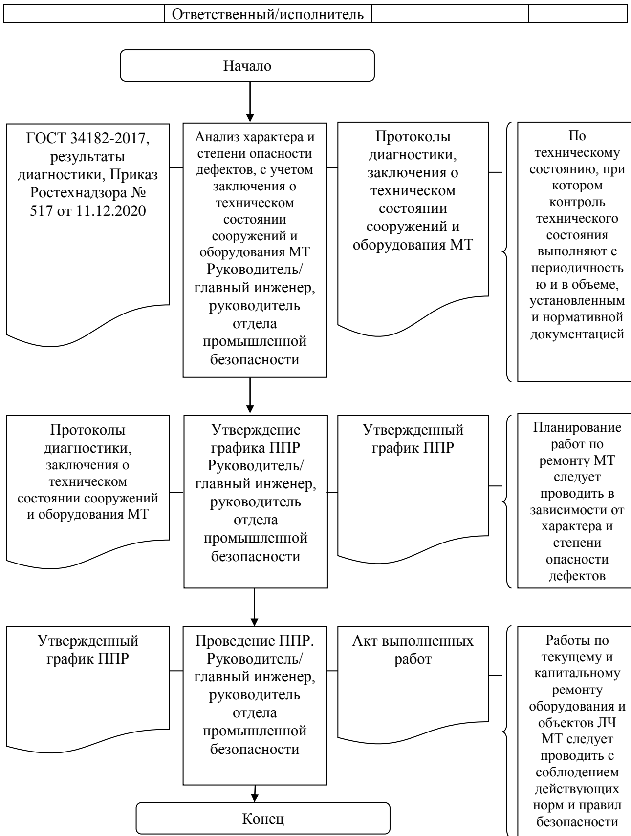
Рисунок 3 - Блок-схема проведения планово-предупредительного ремонта
