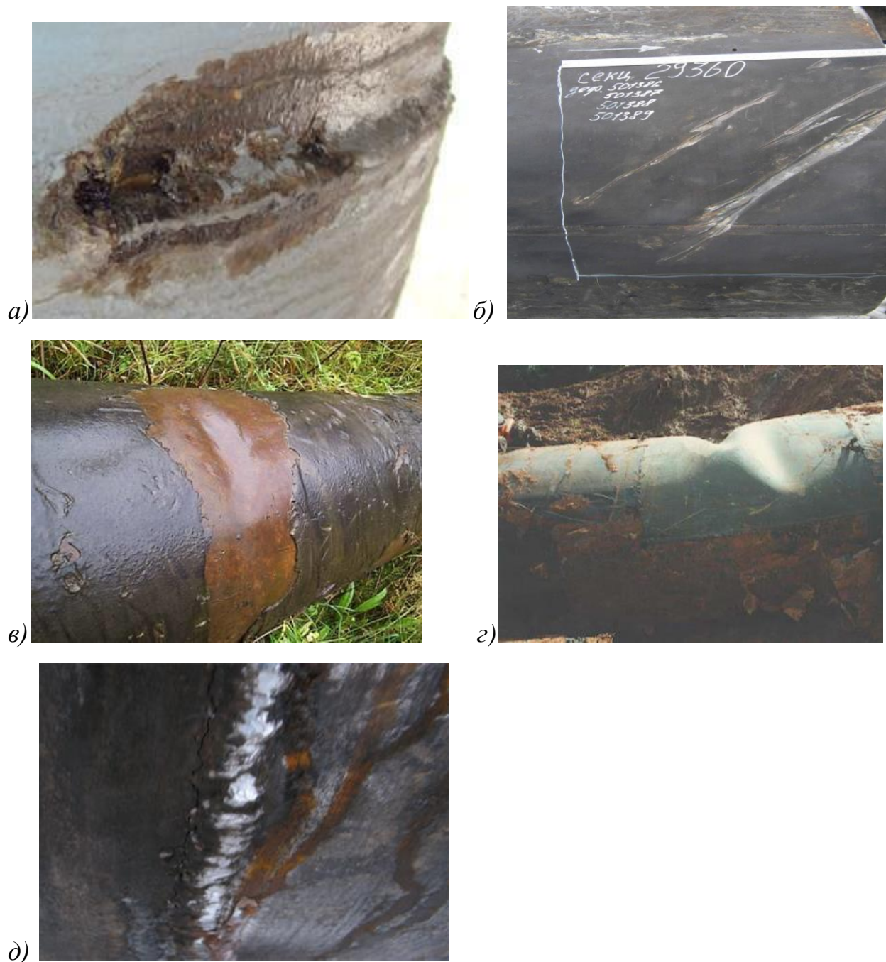
а) потери металла; б) риски; в) вмятины; г) гофры; д) изъяны сварных швов
