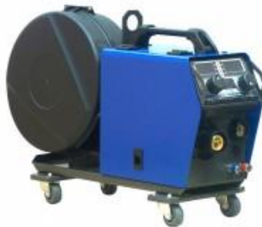
Рисунок 19 – Применяемое для сварки оборудование: источник питания Invertec STT (а) и механизм подачи LF-33 (б)
