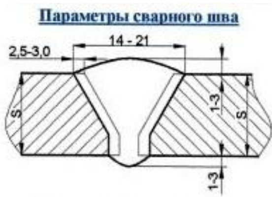
Рисунок 2 – Параметры сварного шва
