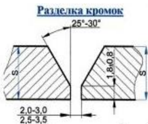
Рисунок 1 – Разделка кромок
