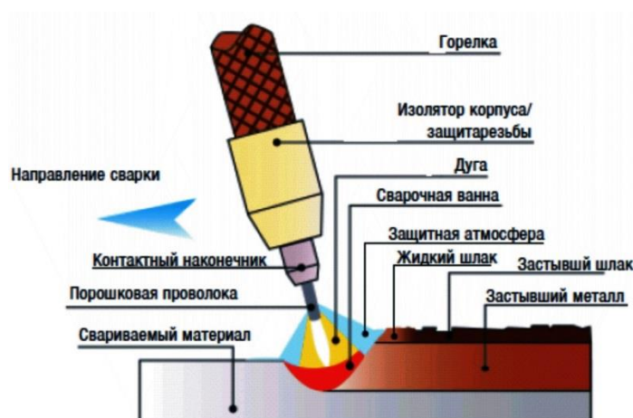
Рисунок 6 – Схема процесса сварки самозащитной порошковой проволокой
