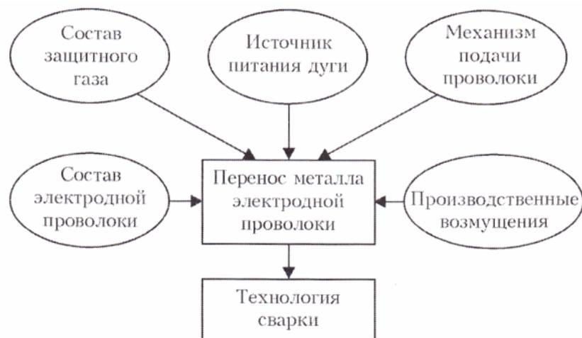
Рисунок 12 – Схема основных параметров сварочного процесса, воздействующих на перенос металла электрода
