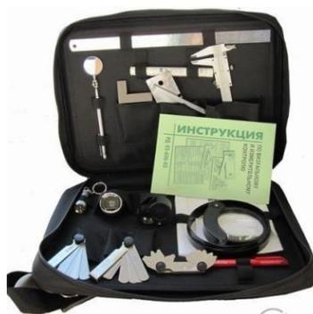
Рисунок 9 – Оборудование для проведения визуально-измерительного контроля
