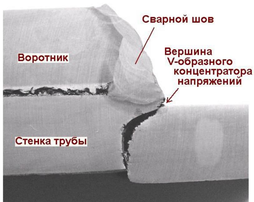
Рисунок 5 – Разрушение соединения в месте концентрации напряжения
