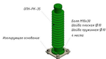
Рисунок 18 – Крепление ОПН к изолирующему основанию
