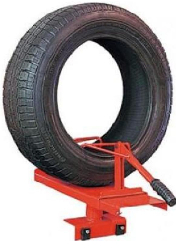
Рисунок 4 – Внешний вид стационарного борторасширителя КС-017
