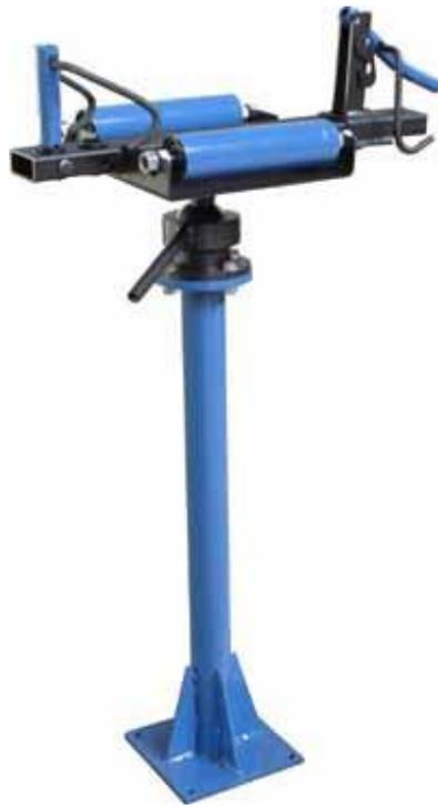
Рисунок 3 – Внешний вид стационарного борторасширителя ПТМ-1
