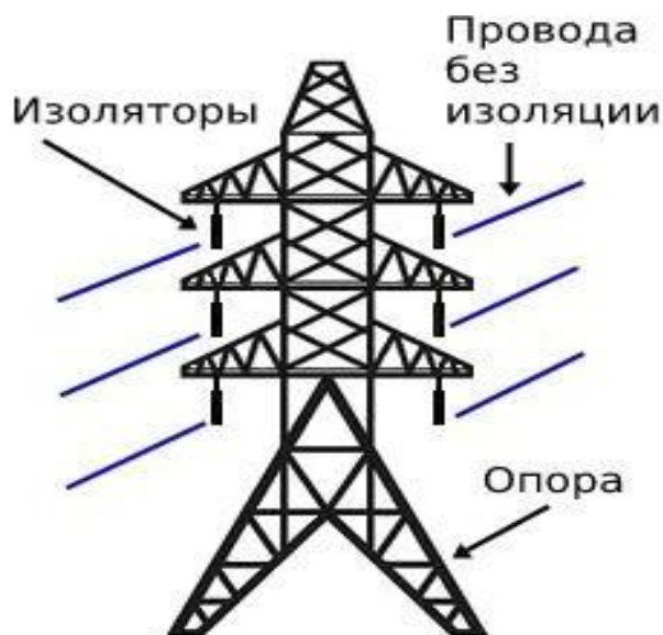
Рисунок 1 - Воздушные линии электропередач
