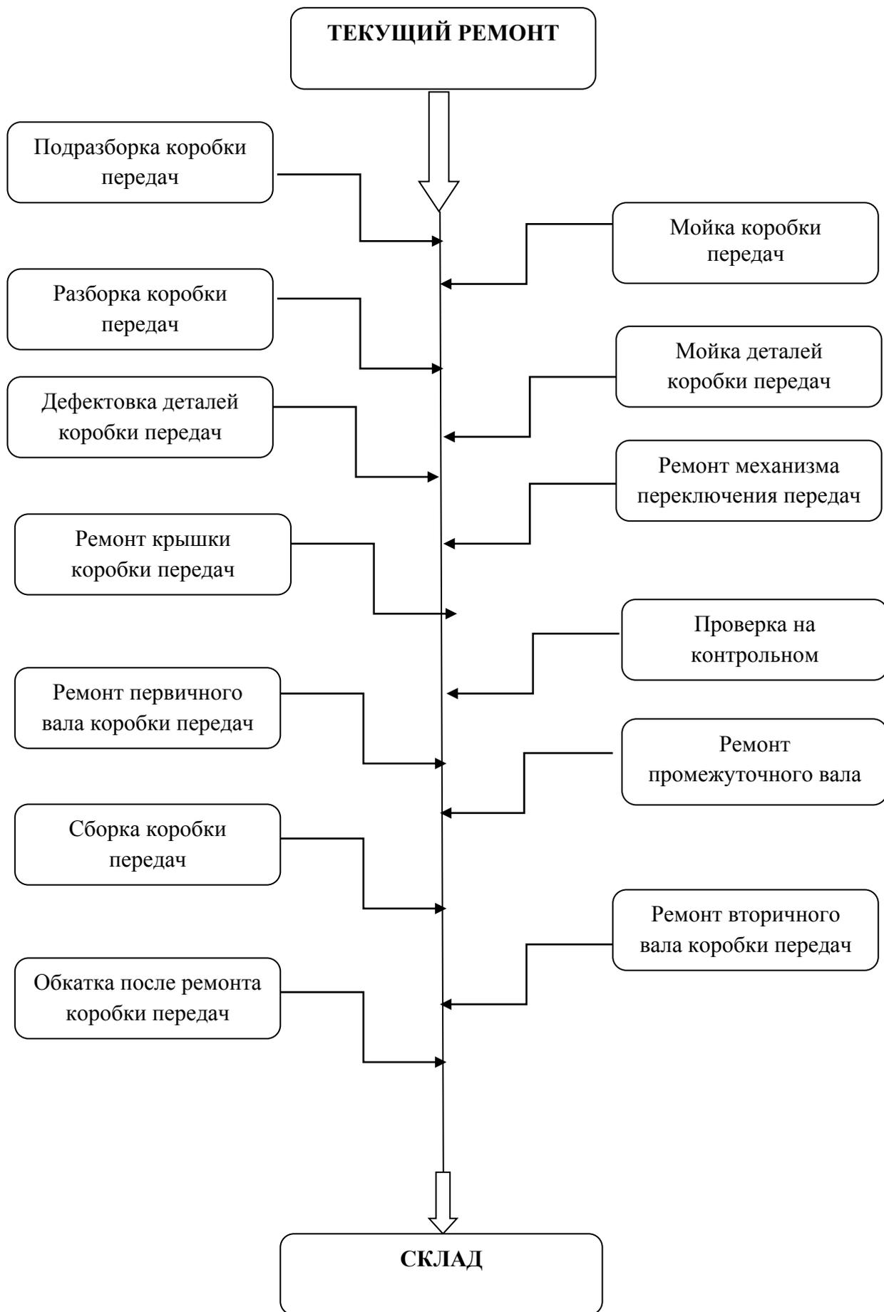
Рисунок 3 - Блок-схема технологического процесса ремонта гидромеханической коробки передач
