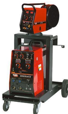
Рисунок 17 – Источник питания Invertec STT-II с механизмом подачи проволоки LF-33
