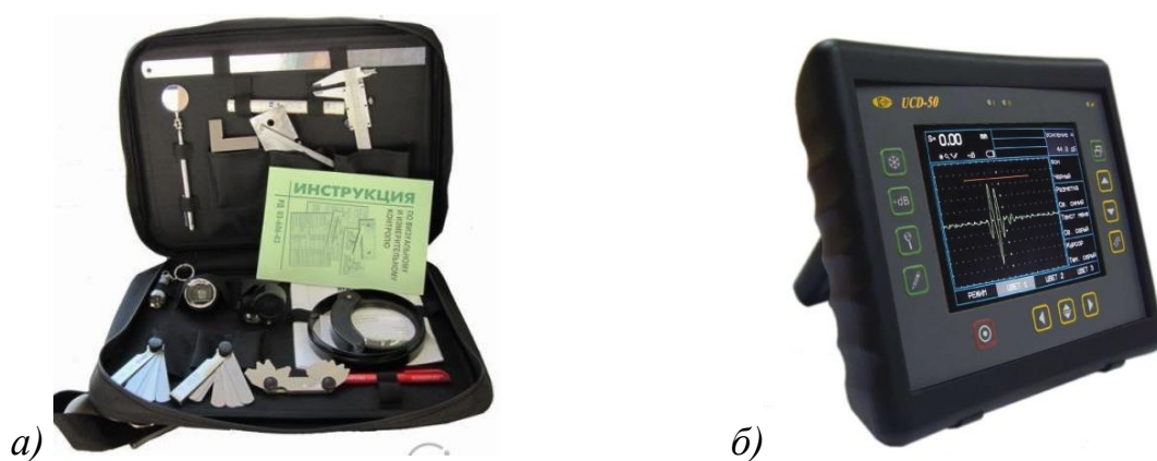
Рисунок 10 – Оборудование для проведения визуально-измерительного контроля (а) и ультразвукового контроля (б) сварных швов
