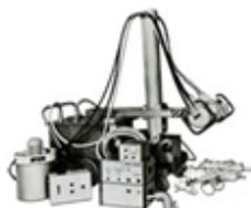
Рисунок 22- Рентгеновский аппарат типа РАП 150/300-10
