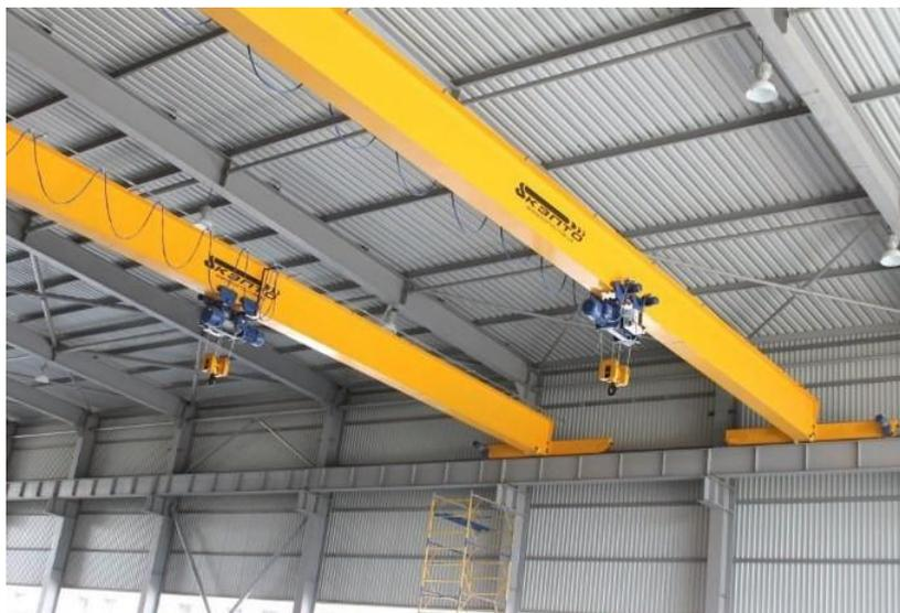
Рисунок 15 – Мостовой однобалочный кран
