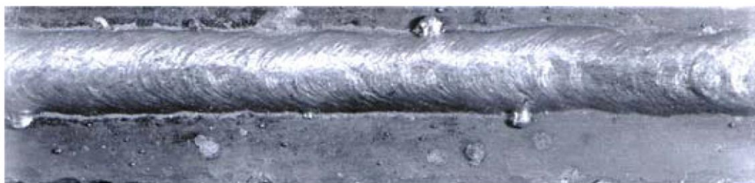
Рисунок 4 – Схема наплавки порошковой проволокой
