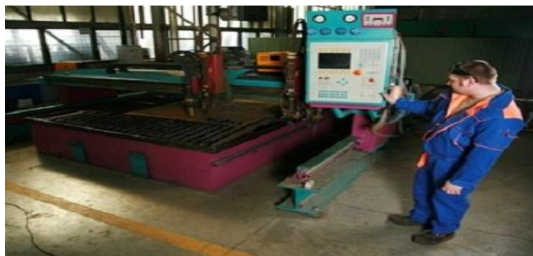
Рисунок 2-Аппарат с числовым программным управлением плазменной резки На следующем этапе детали поставляются на дробеструйную
