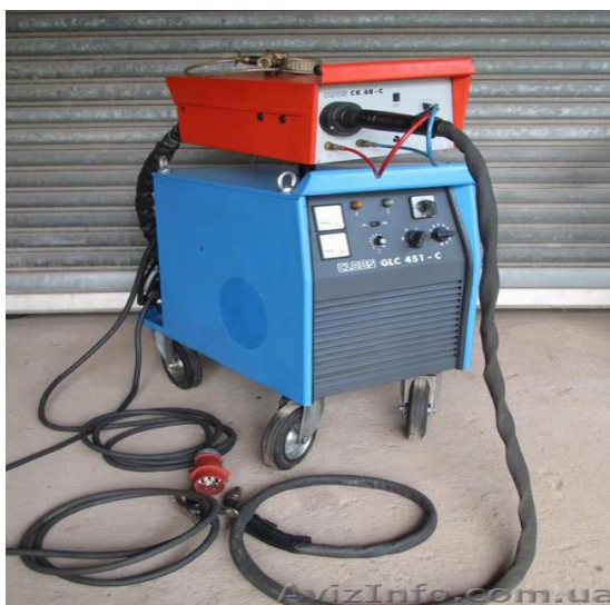
Рисунок 5 - Сварочный полуавтомат Cloos GLC 451-C
