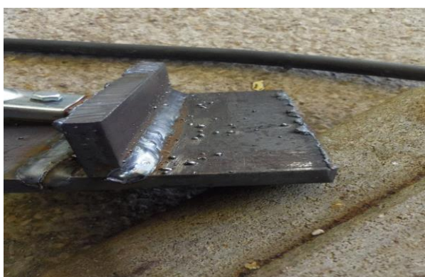
Рисунок7-Околошовная зона с брызгами при механизированной сварке в \text{CO}_2
