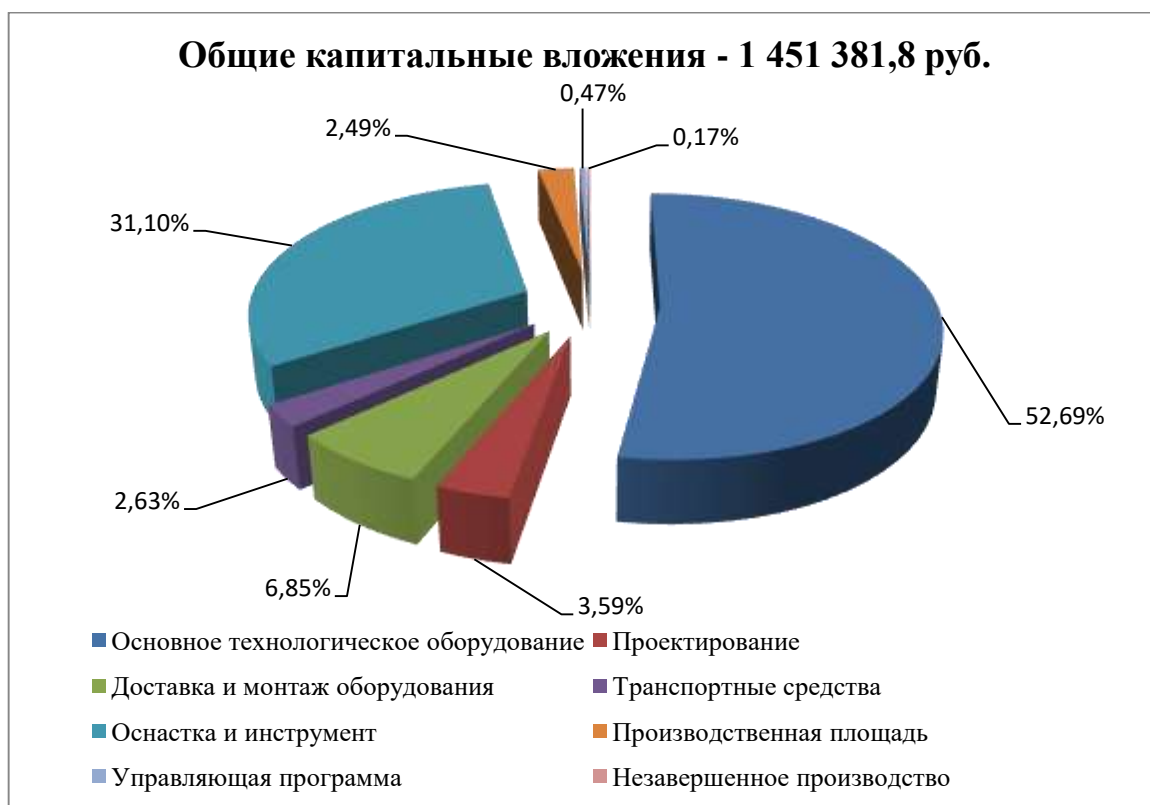
Рисунок 9 – Величина показателей, из которых формируются общие капитальные вложения в изготовление детали «Ушко переднего карданного вала», руб.
