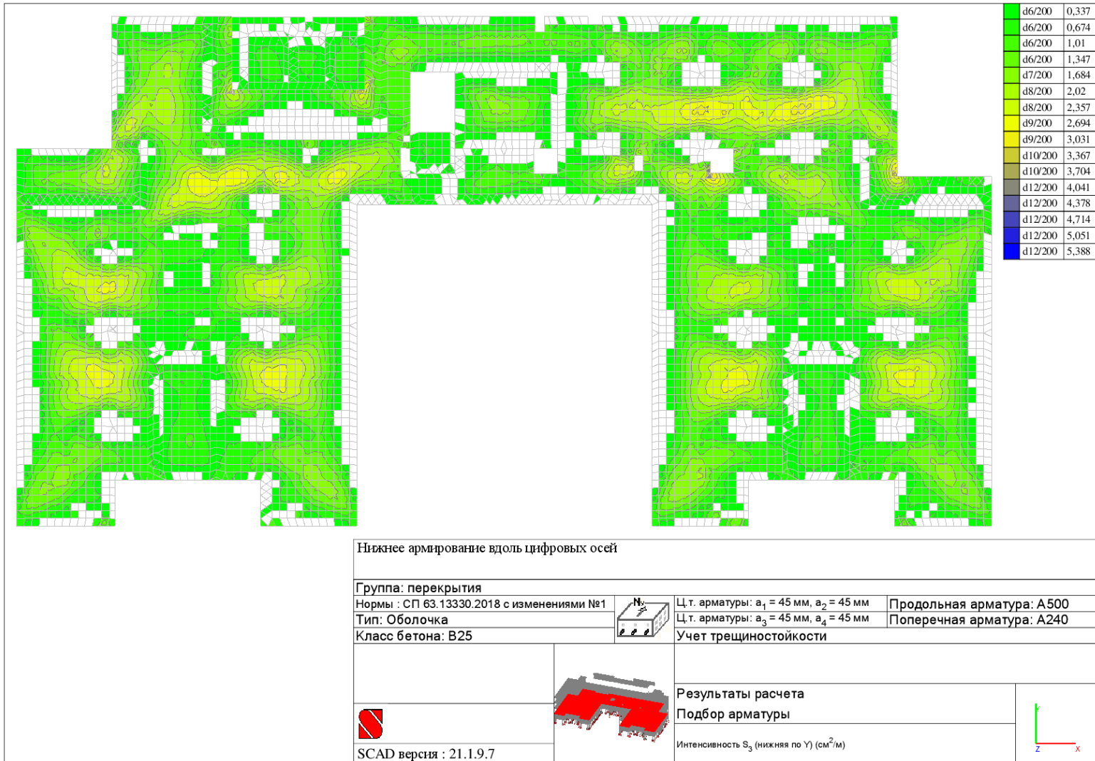
Рисунок Б.2 – Нижнее армирование вдоль цифровых осей
