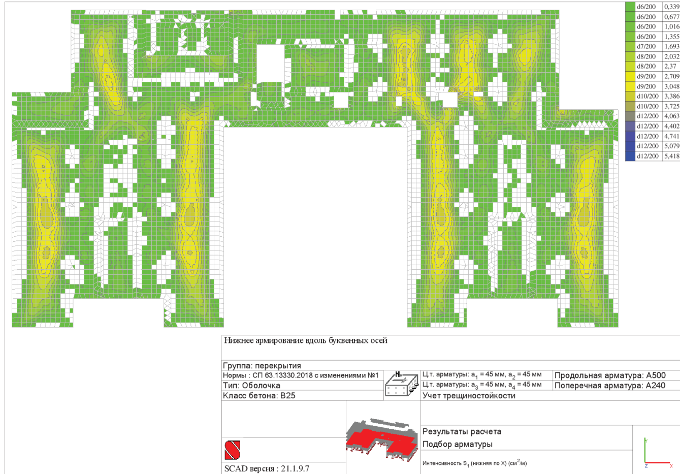
Рисунок Б.1 – Нижнее армирование вдоль буквенных осей
