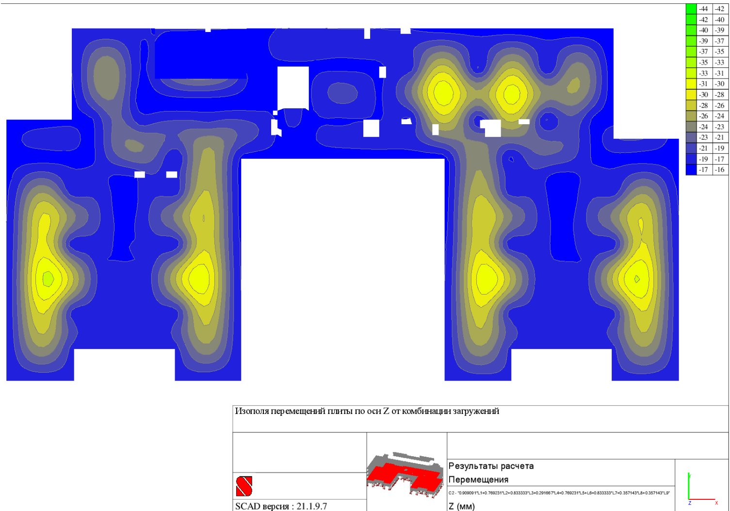
Рисунок Б.6 – Изополя перемещений плиты по оси Z от комбинации нагрузок
