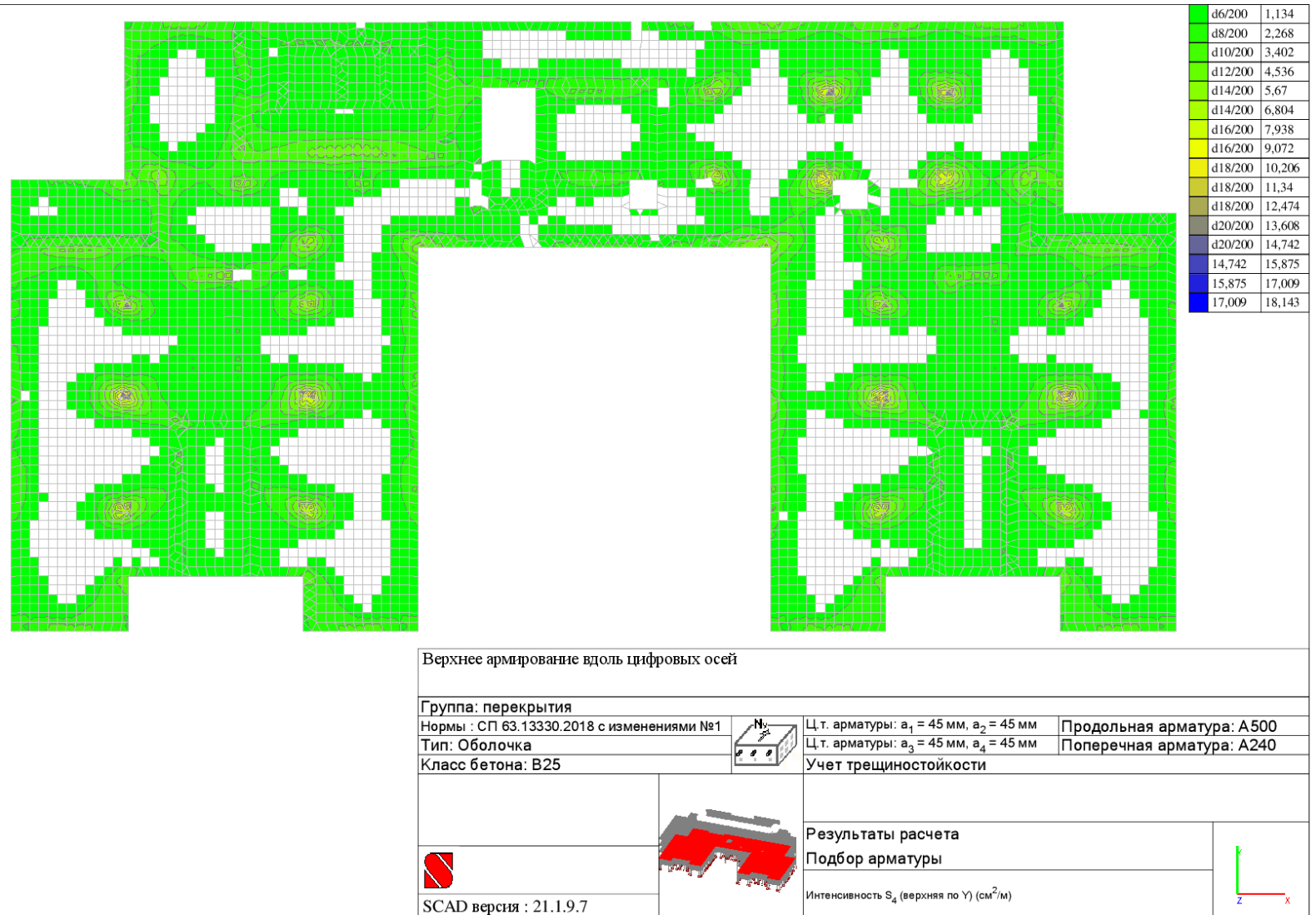
Рисунок Б.4 – Верхнее армирование вдоль цифровых осей
