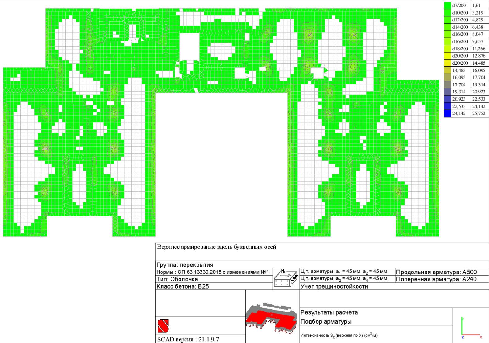
Рисунок Б.3 – Верхнее армирование вдоль буквенных осей
