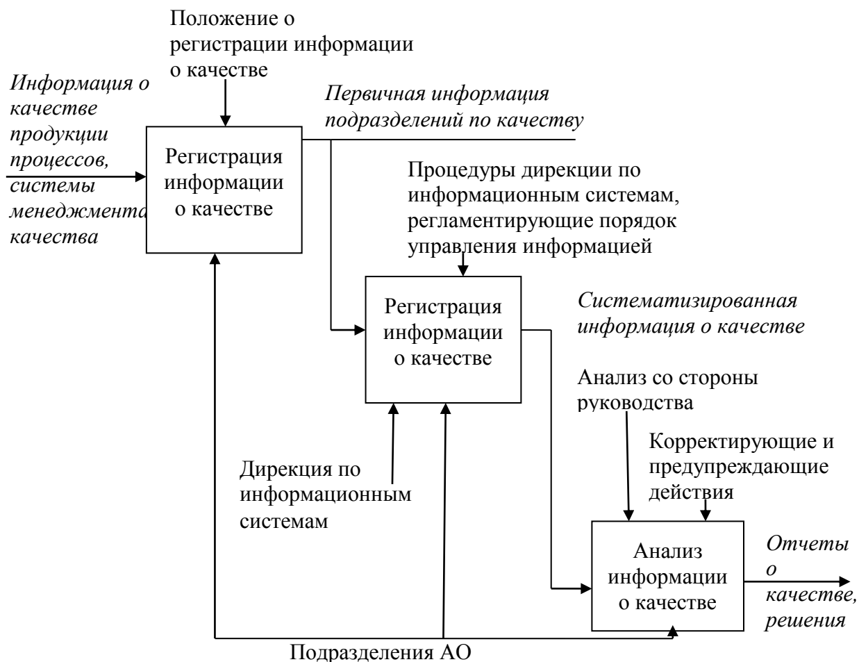
Рисунок 8 – Графическая модель управления регистрацией информации о качестве в системе менеджмента качества АО «АВТОВАЗ»
