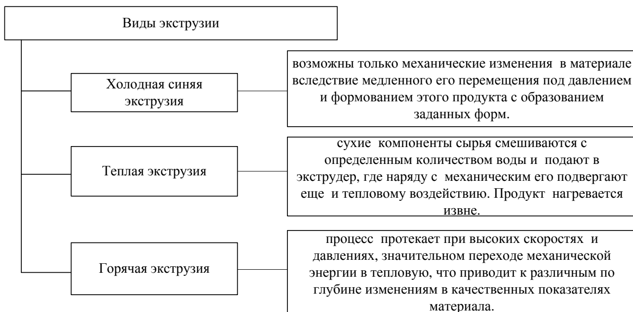
Рисунок 2 – Виды экструзии
