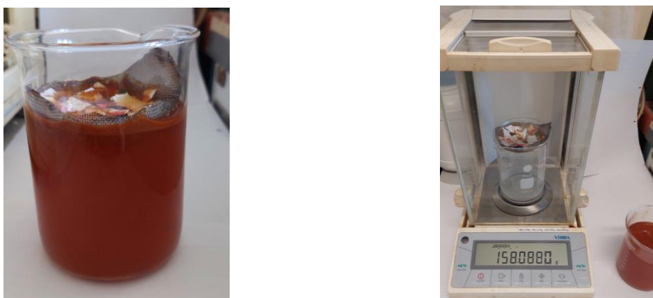
Рисунок 12 – Экспериментальная установка для определения нефтеемкости полиэтиленового флекса
