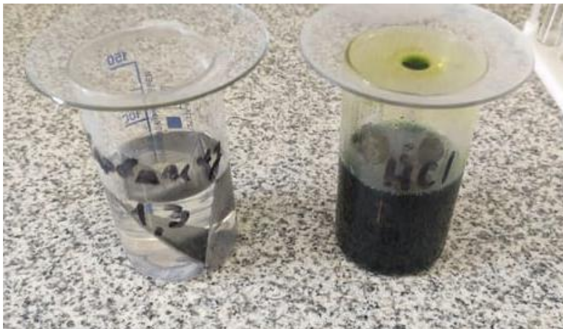
Рисунок 27 - Образцы в коррозионной среде
