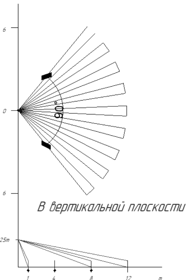
Рисунок 11- Зона контролируемого пространства извещателя «Астра-5»
