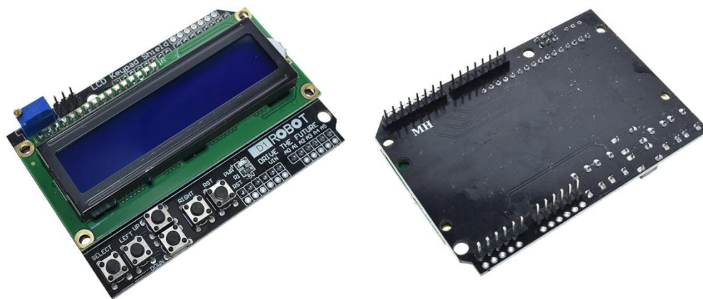
Рисунок 11 – Внешний вид платы расширения LCD Keypad МК
