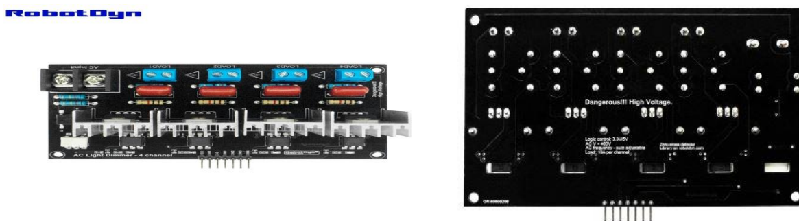
Рисунок 13 – Внешний вид платы управления нагрузками
