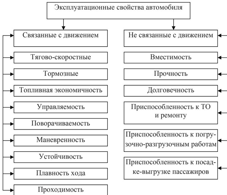
Рис. 1.1. Эксплуатационные свойства автомобиля
