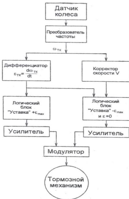
Рис. 3.10. Блок-схема управления АБС
