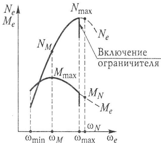
Рис. 2.2. Внешняя скоростная характеристика бензинового двигателя с ограничителем оборотов
