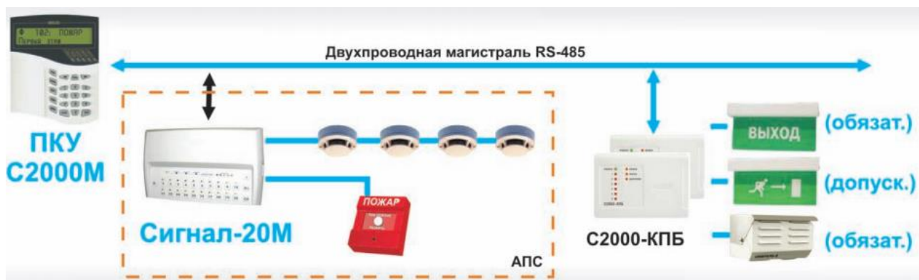
Рисунок 10 – Система оповещения и управления эвакуации людей при пожаре 2-го типа на базе «Болид»
