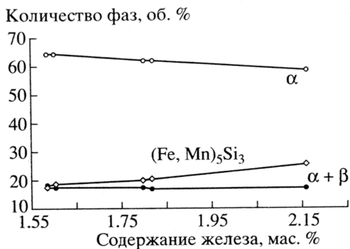
Рисунок 7 – «Изменение объёмной доли фаз в латуни ЛМцАЖКС в зависимости от содержания железа» [3]
