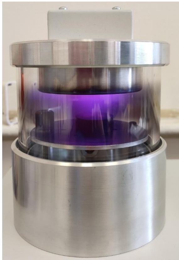
Рисунок 19 – Ионизация плазмы в процессе напыления образца
