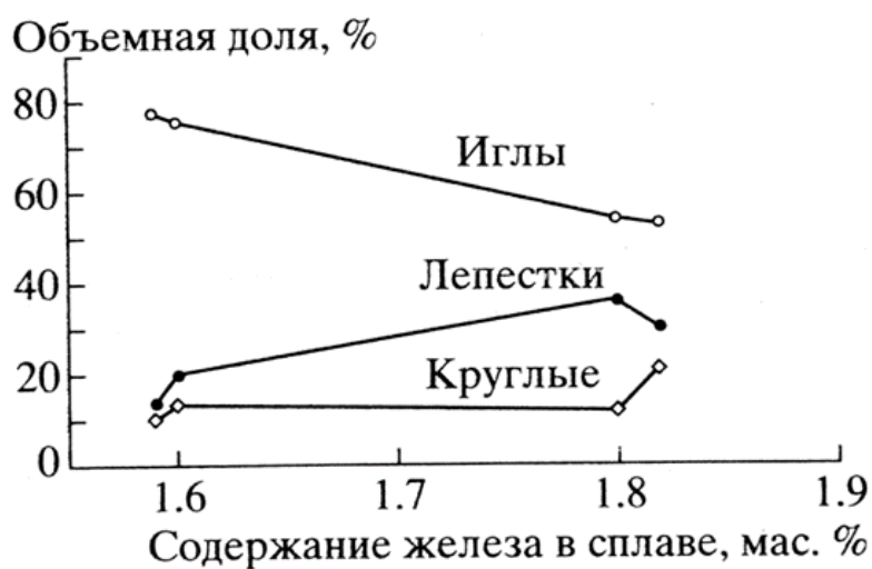
Рисунок 8 – «Объёмная доля силицидов с разной формой частиц в зависимости от содержания железа в латуни ЛМцАЖКС» [46]
