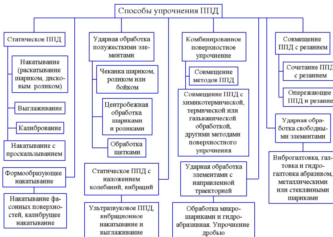
Рисунок 2 – основные методы поверхностного пластического деформирования
