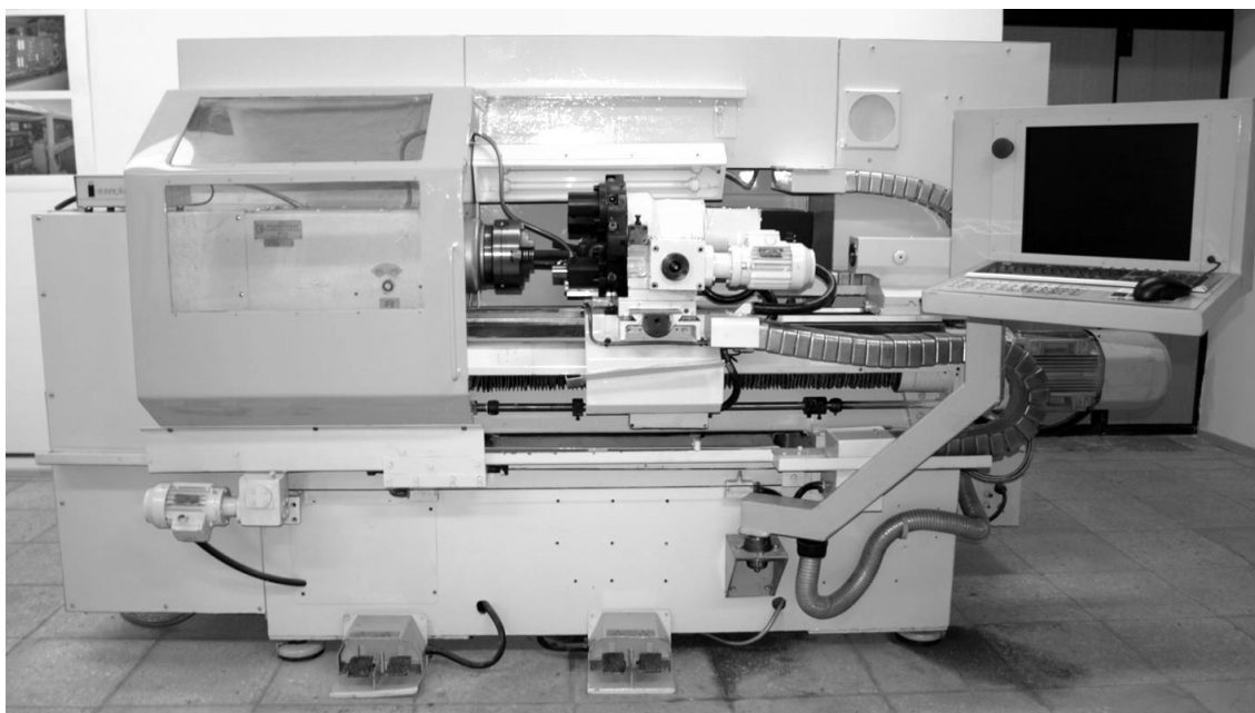
Рисунок 10 – станок токарный с ЧПУ 16П16Т1С1, оснащенный для УЗО
