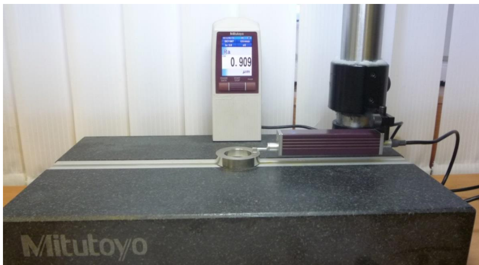
Рисунок 15 – Лабораторная фиксация шероховатости прибором Mitutoyo SJ-210
