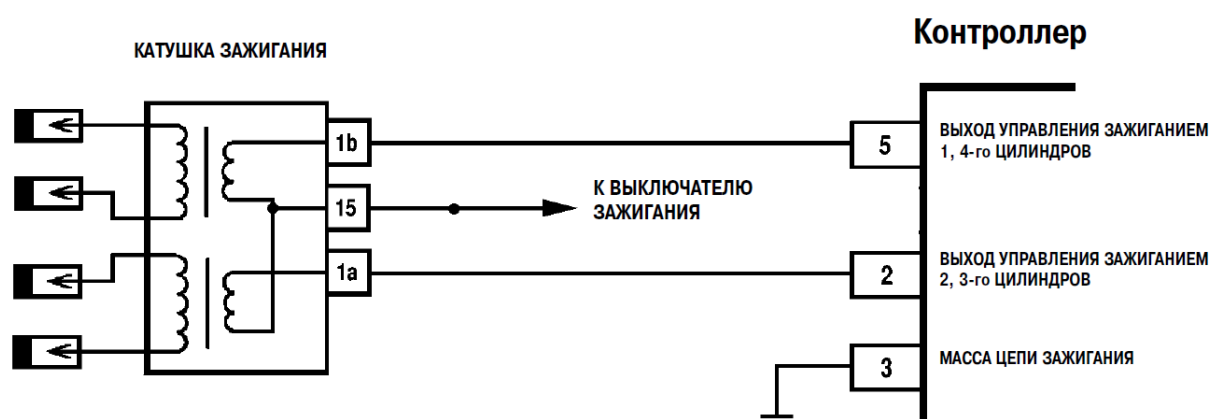
Рисунок 1.16 – Схема подключения катушки зажигания
