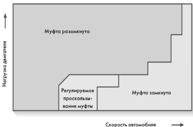
Рис. 2.10. Режимы работы муфты блокировки гидротрансформатора при установке рычага селектора в положение «D» (в качестве примера)
