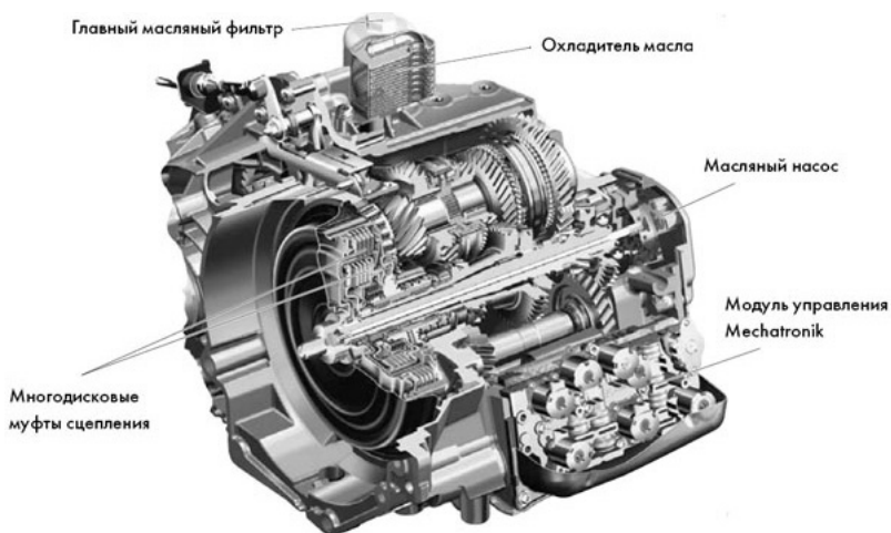
Рис. 3.18. Трансмиссия «DSG» концерна Volkswagen
