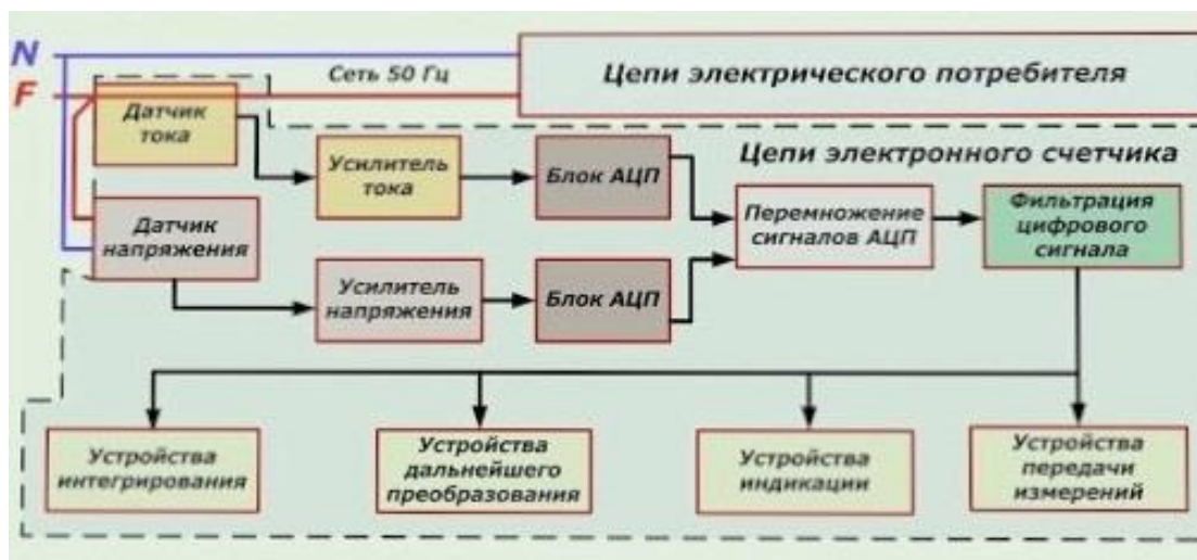
Рисунок 8 – структурная схема электронного счетчика
