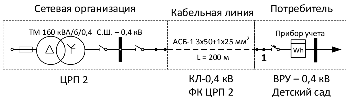
Рисунок 2 – Схема внешнего электроснабжения дошкольного образовательного учреждения
