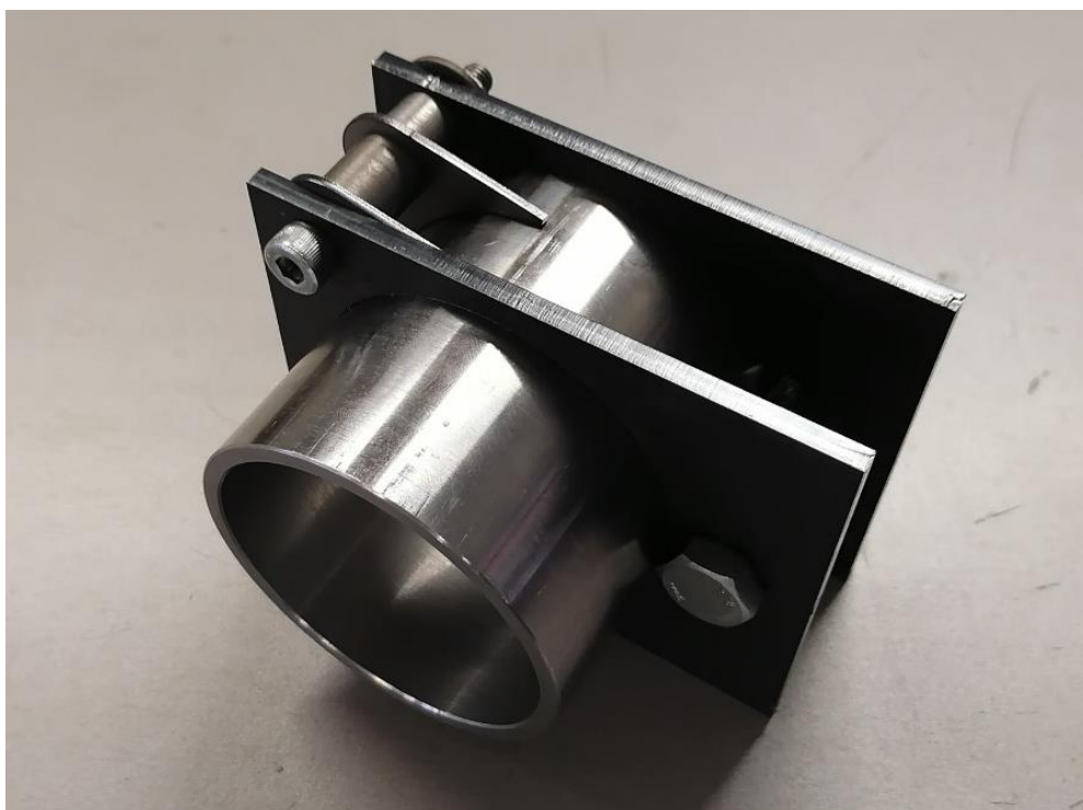
Рисунок 21 – Сборка гильзы в стапеле.
