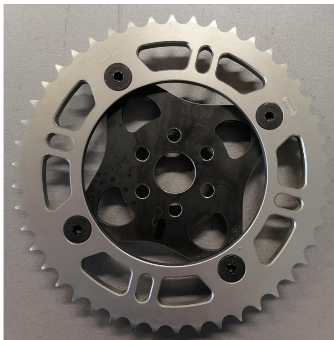
Рисунок 19 – Ведомая звезда с проставкой на ШРУС электроболрида 2021 года на 45 зубьев
