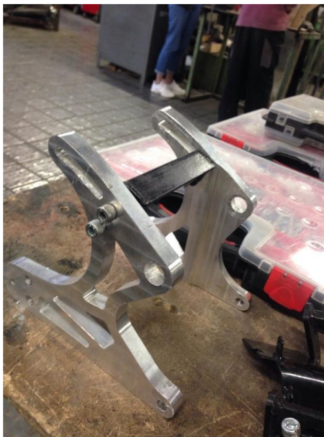
Рисунок 17 – Кронштейны крепления дифференциала в сборе болида Scorpion G2
