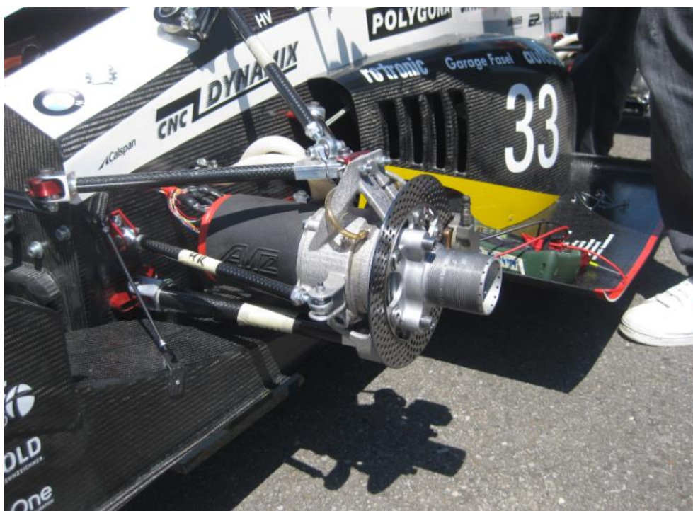
Рисунок 2 - Мотор-колесо Швейцарской команды EPFL Racing Team, интегрированное в поворотный кулак
