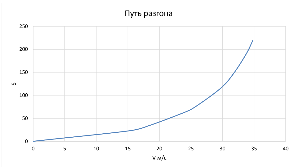
Рисунок 10 – Путь разгона автомобиля
