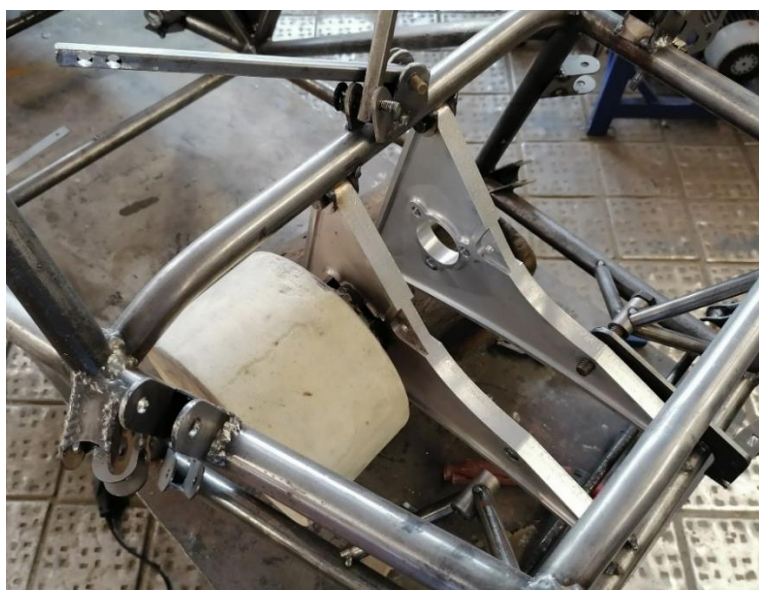
Рисунок 16 – Плиты в сборе, с макетом электродвигателя.
