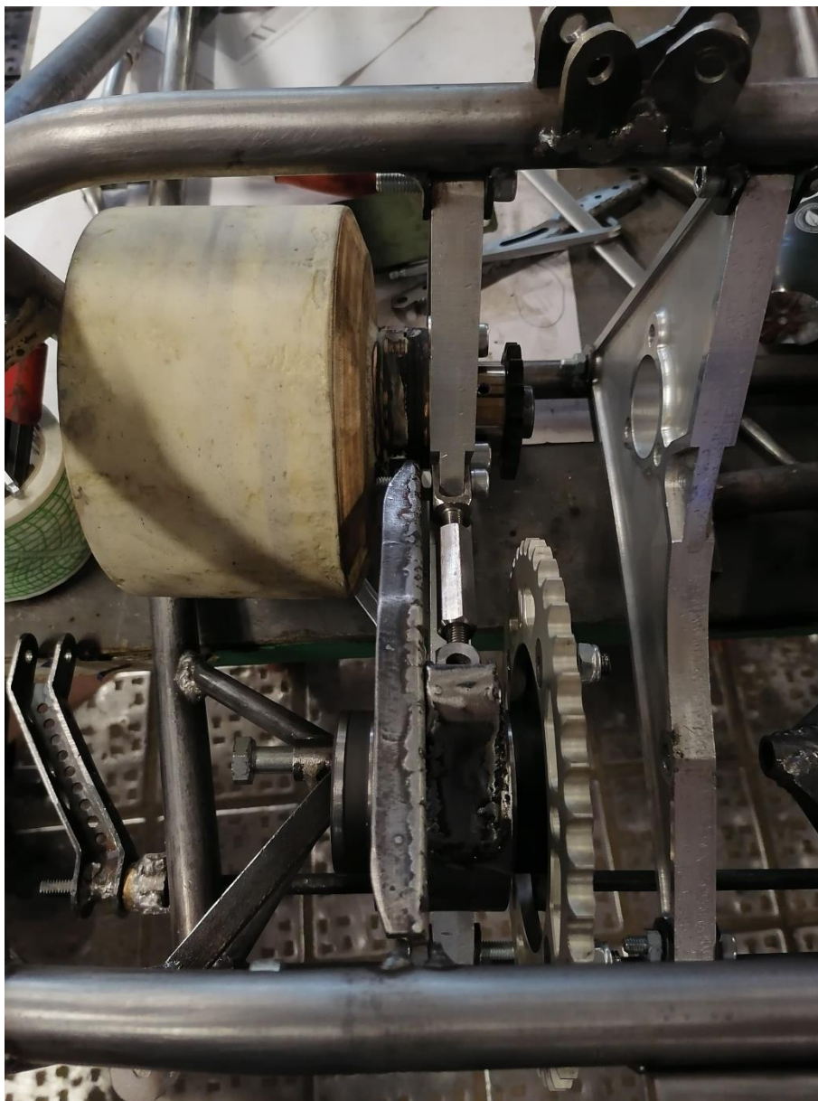
Рисунок 23 – Тяговый узел в сборе, с макетом электродвигателя.
