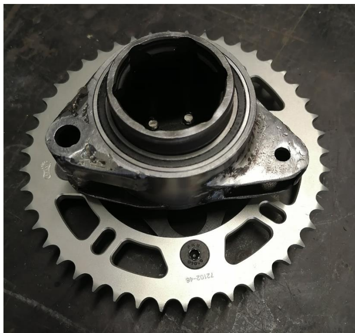
Рисунок 24 – Ведомая звезда с гильзой в сборе.
