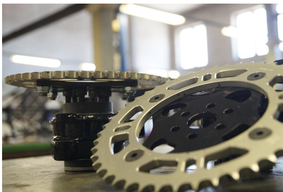
Рисунок 25 – Ведомая звезда с переходной пластиной к ШРУС.
