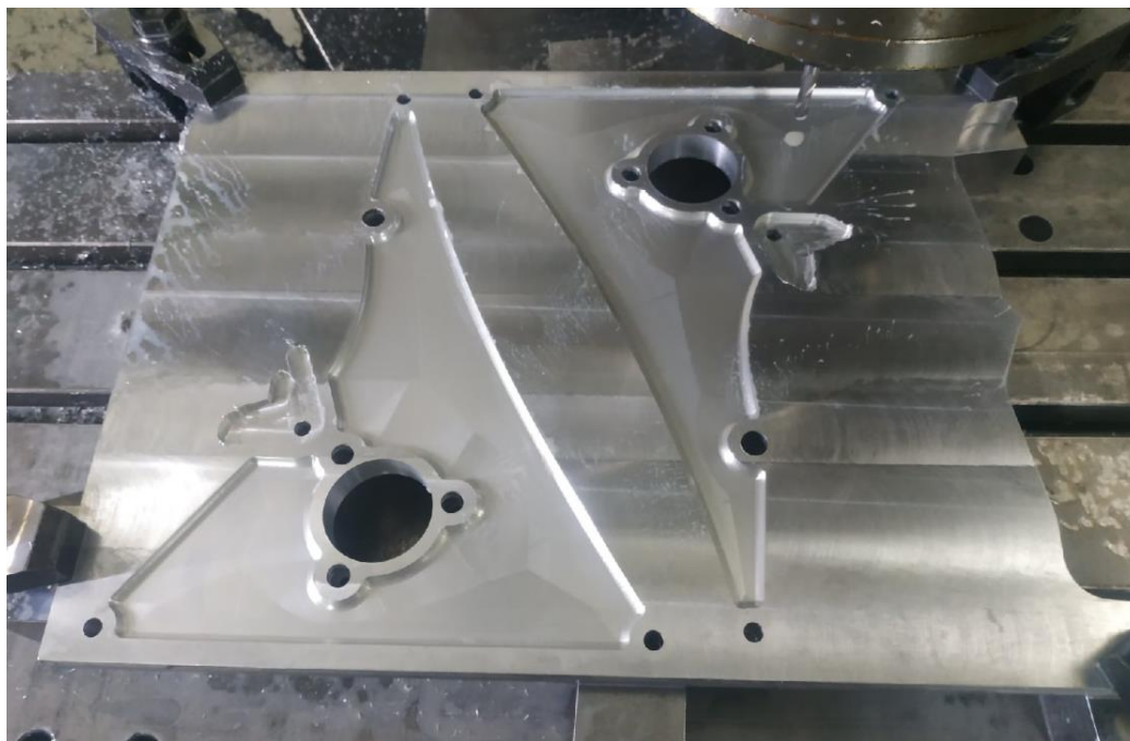
Рисунок 22 – Изготовления кронштейнов крепления тягового узла.
