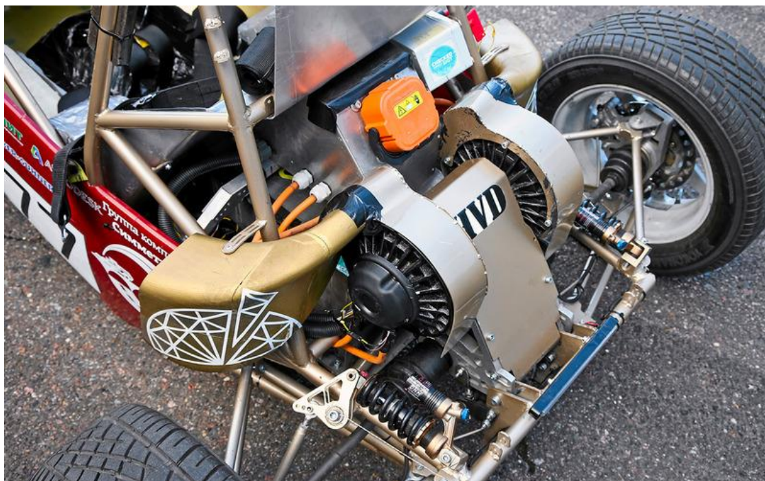
Рисунок 1 - Конструкция трансмиссии болида университета МАДИ
