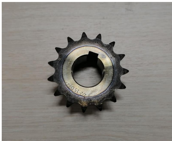
Рисунок 18 – Ведущая звезда на электроболрид 2021 года на 15 зубьев
