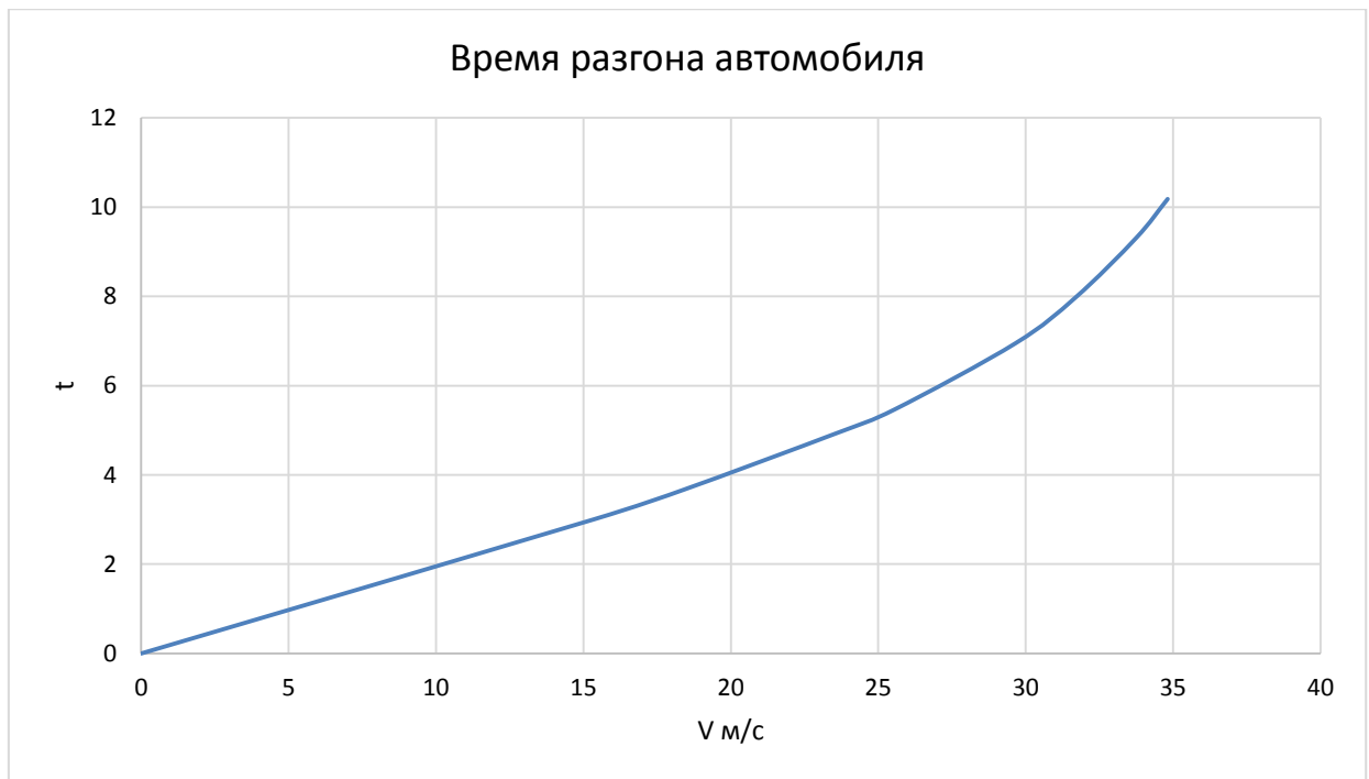
Рисунок 9 – Время разгона автомобиля
