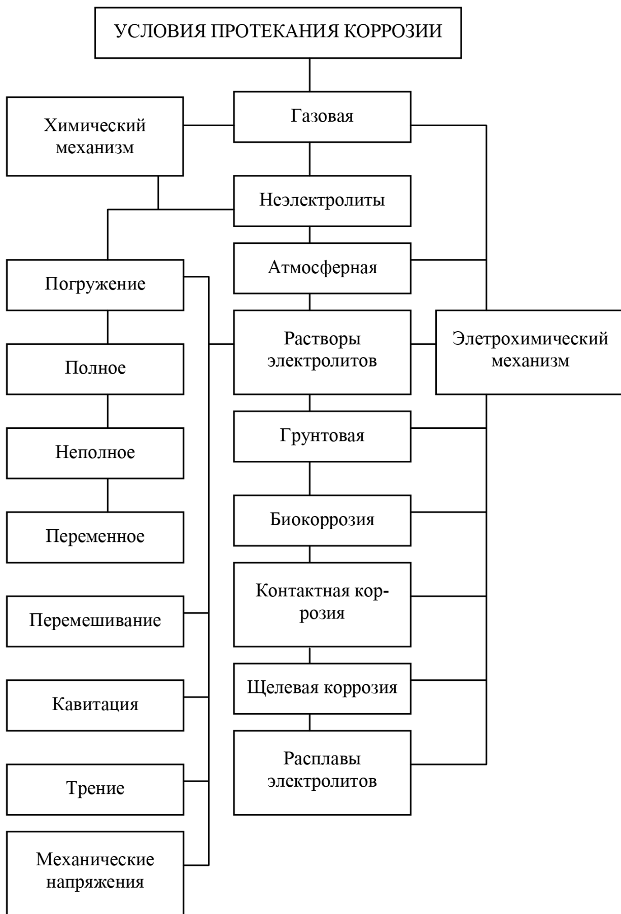
Рисунок 1 – Условия протекания коррозии
