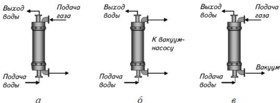
a – продувка; б –создании вакуума; в – комбинированная
