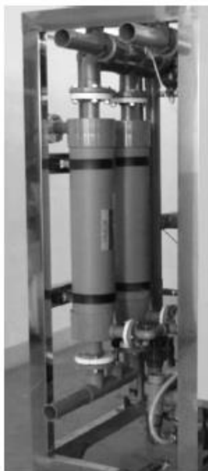
Рисунок 39 – Установка для удаления растворенного O_2 производительностью 18 м 3 /ч, состоящая из 3 параллельных цепочек по 2 модуля типа 6×28. Обеспечивает остаточное содержание O_2 менее 0,5 мкг/л при исходном содержании 9 мг/л. Температура 15 °С
