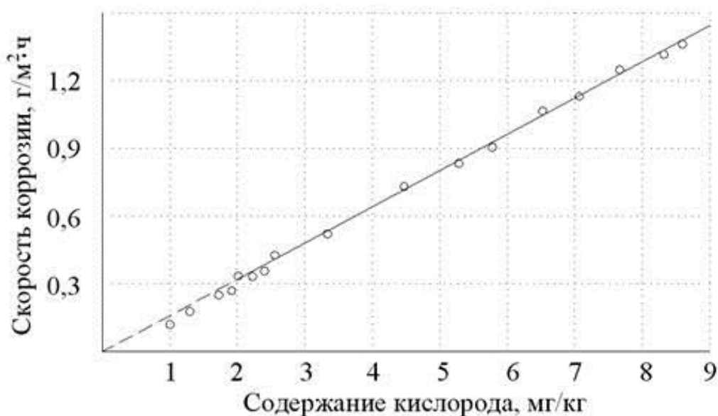
Рисунок 4 – Зависимость скорости коррозии стали от содержания кислорода
