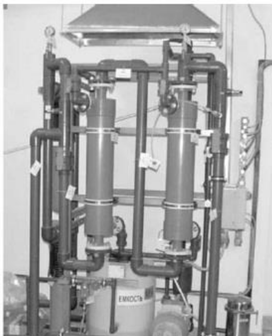
Рисунок 39 – Установка для удаления растворенного O_2 производительностью 18 м 3 /ч, состоящая из 3 параллельных цепочек по 2 модуля типа 6×28. Обеспечивает остаточное содержание O_2 менее 0,5 мкг/л при исходном содержании 9 мг/л. Температура 15 °С
