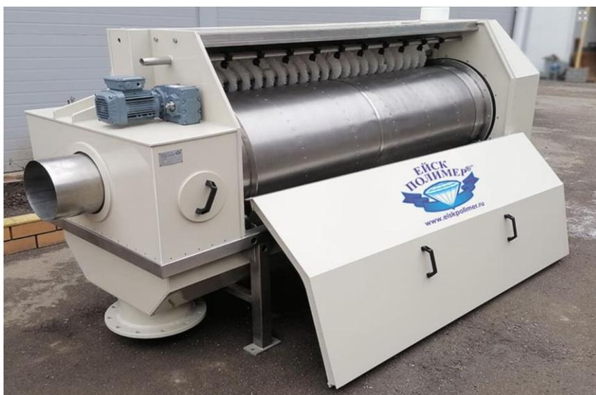
Рисунок 40 – Механическое барабанное сито
