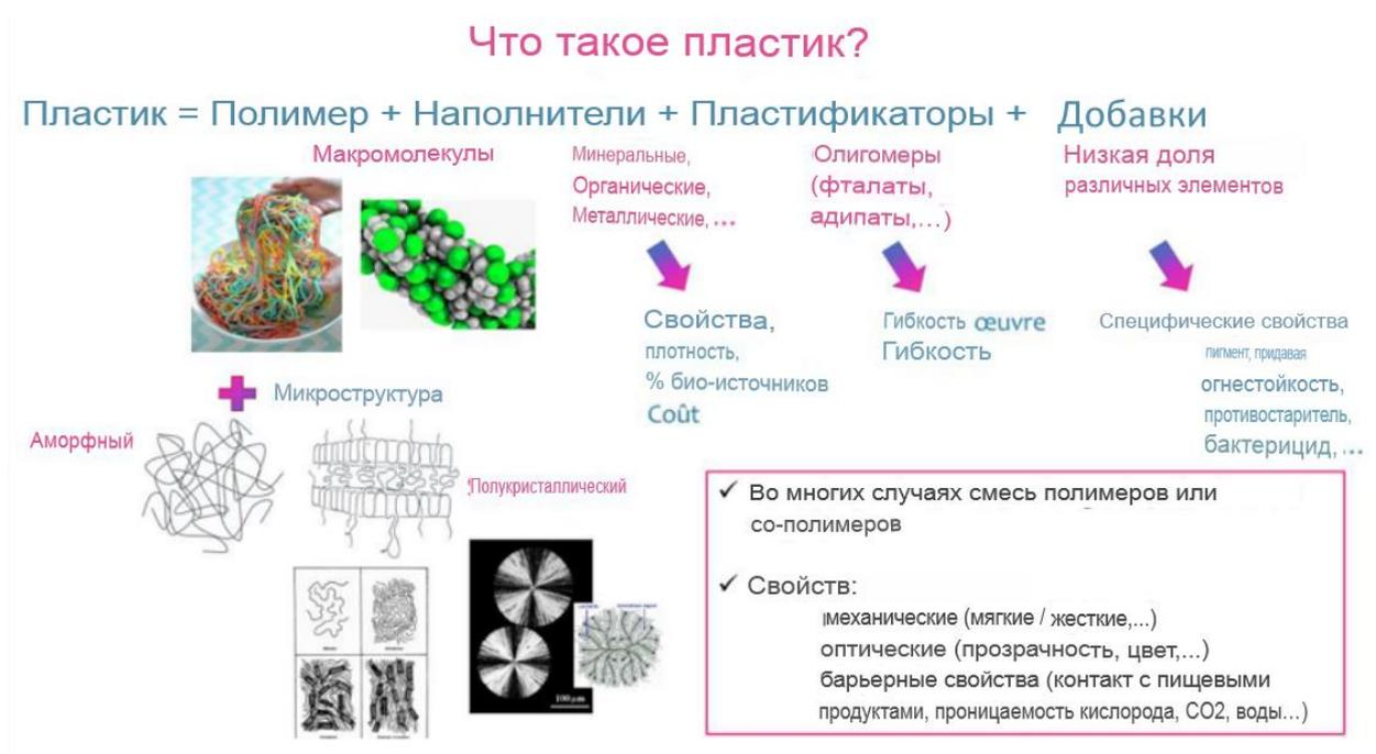
Рисунок 14 – Состав и структура пластика
