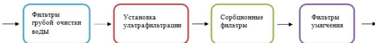
Рисунок 27 – Компоновки системы ультрафильтрации (Вариант 3)
