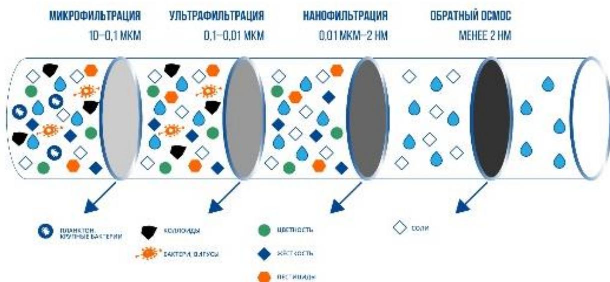
Рисунок 31 – Степень очистки воды в зависимости от параметров мембраны
