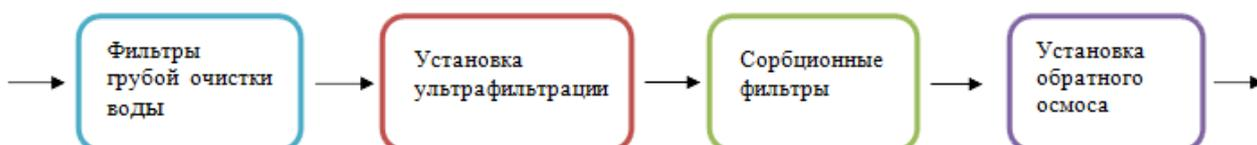
Рисунок 28 – Компоновки системы ультрафильтрации (Вариант 4)
