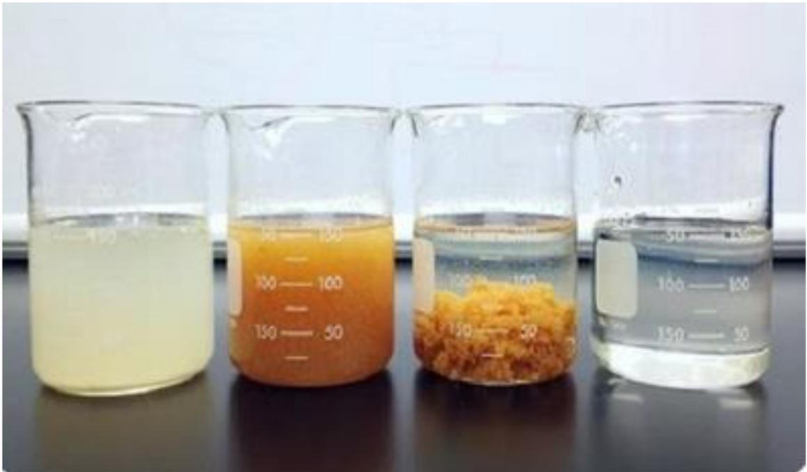
Рисунок 15 – Процесс протекания флокуляции
