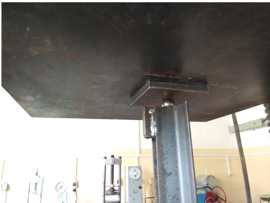
Рисунок 24 – Верхняя шаровая опора
