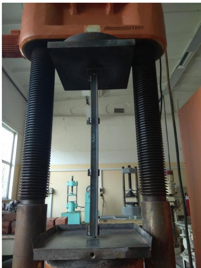
Рисунок 29 – Испытание эталонных стержней
