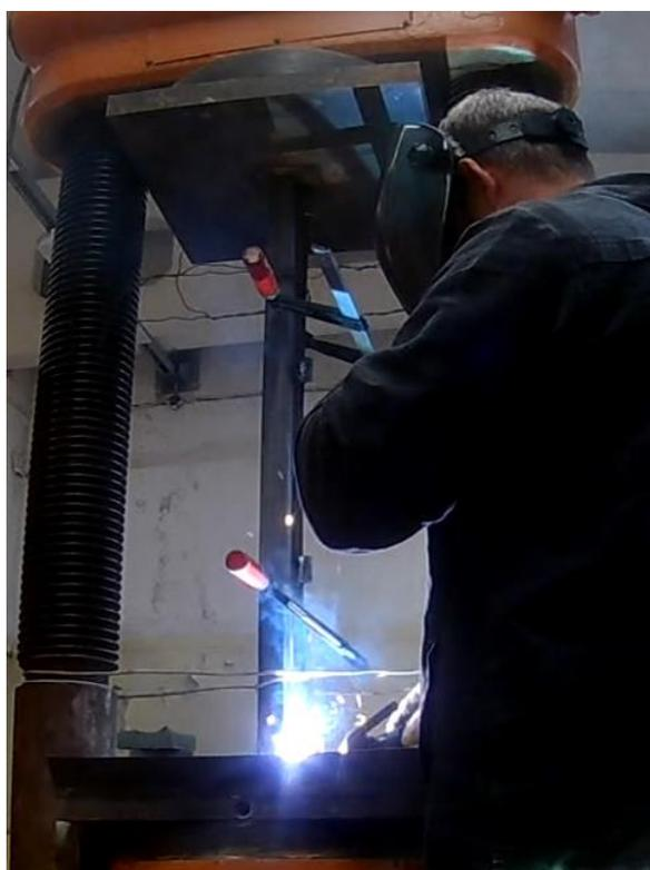
Рисунок 31 – Усиление стержней
