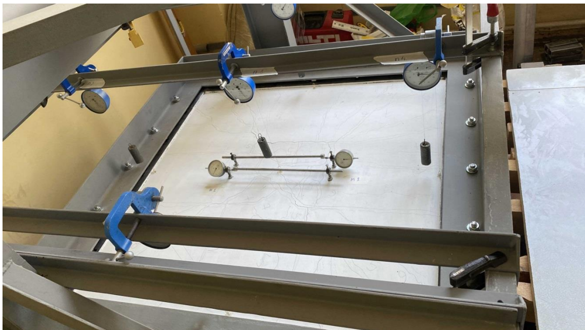
Рисунок 28 – Установка мессур на модель полнотелой плиты
