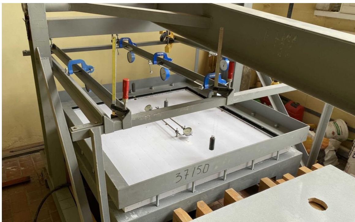
Рисунок 31 – Испытываемая модель плиты со сферическими пустотообразователями подготовлена к проведению испытания, прогибомеры и мессуры установлены
