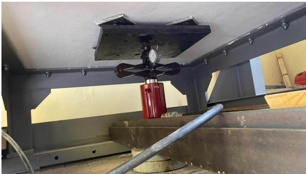
Рисунок 24 – Установка нагружающего домкрата с динамометром NC123, пластин и металлических шариков
