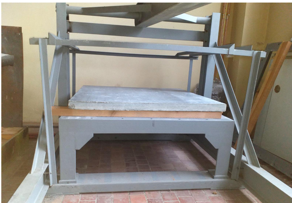
Рисунок 23 – Модель железобетонной монолитной плиты установлена в испытательный стенд (показана модель плиты перекрытия сплошного сечения)
