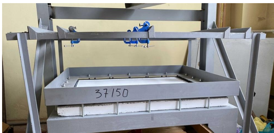
Рисунок 26 – Установка каркаса из уголков над моделью плиты (показана модель плиты сплошного сечения)
