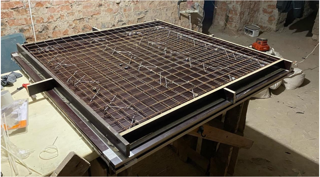
Рисунок 14 – Армирование формы для образца модели железобетонной плиты сплошного сечения
