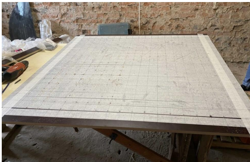
Рисунок 13 – Основание формы для изготовления модели плиты со сферическими пустотообразователями
