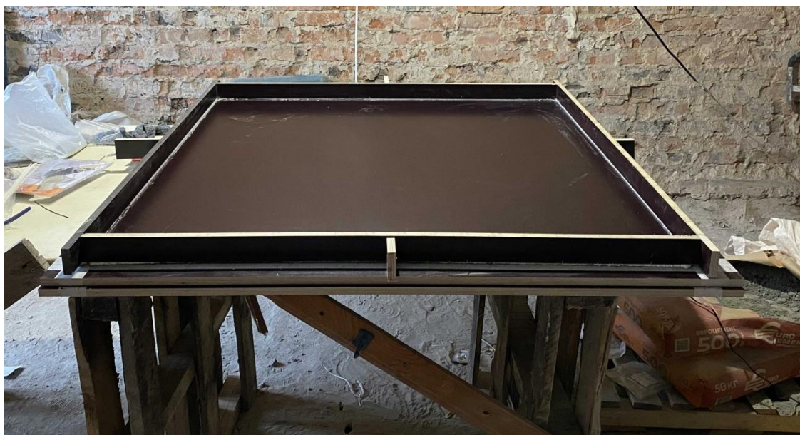
Рисунок 12 – Форма для изготовления модели плиты сплошного сечения
