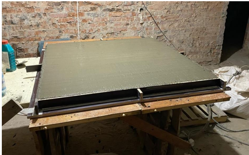
Рисунок 17 – Бетонирование форм (на фотографии показана 1 модель)
