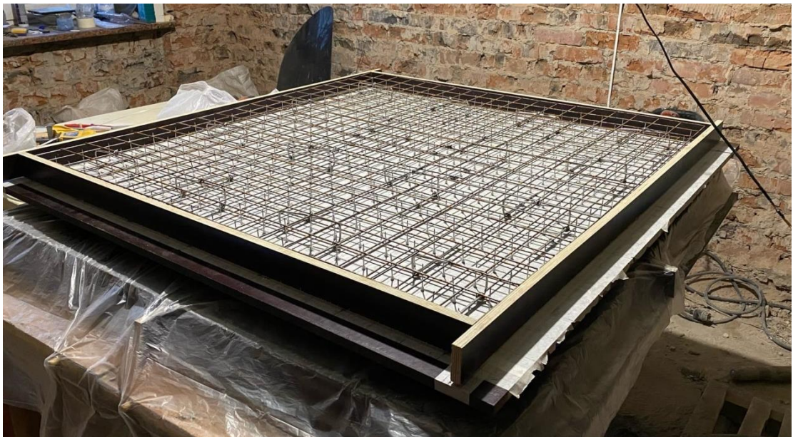
Рисунок 15 – Армирование формы для модели железобетонной плиты со сферическими пустотообразователями
