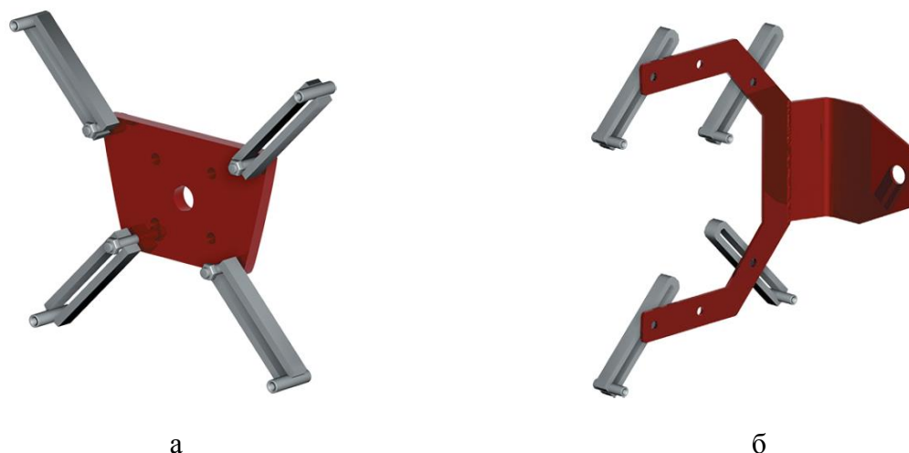
Рисунок 14 – Сменные держатели: а) держатель двигателя 8.54; б) держатель КП 8.55.
