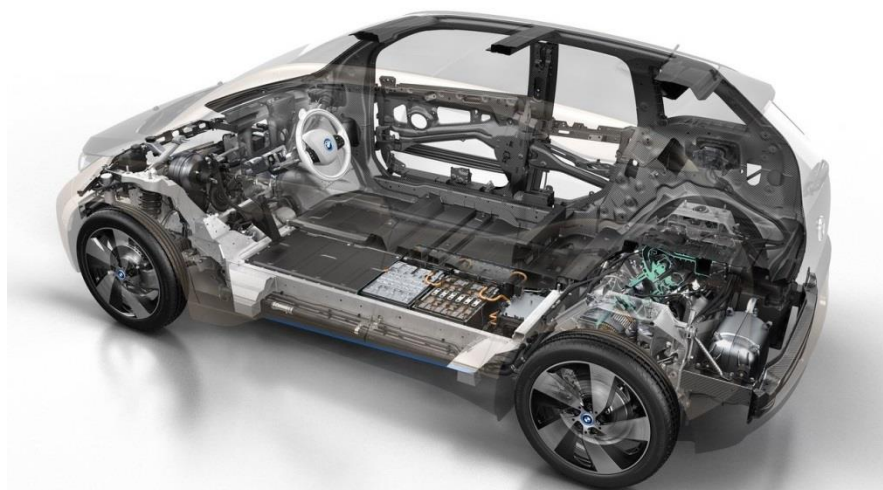
Рисунок 8 - Схема компоновки автомобиля BMW i3 [18]
