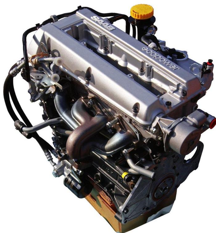
Рисунок 1 – Общий вид двигателя SAAB B234 взятого как базовый для расчета
